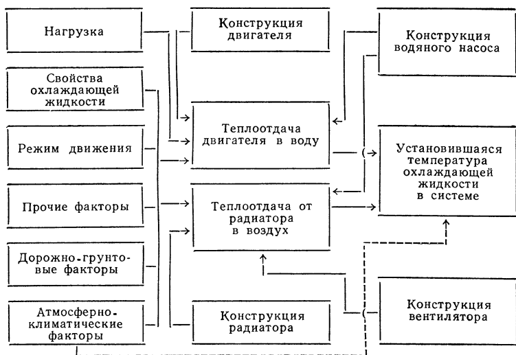
Рис. 4.1. Структурная схема взаимосвязи потенциальных свойств системы жидкостного охлаждения автотракторного двигателя, внешних факторов и измерителей температурно-динамической характеристики
